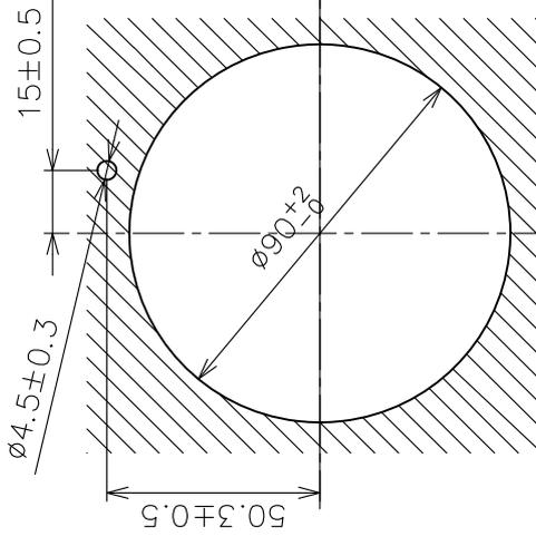
取付穴寸法図 (壁厚10mまで)
